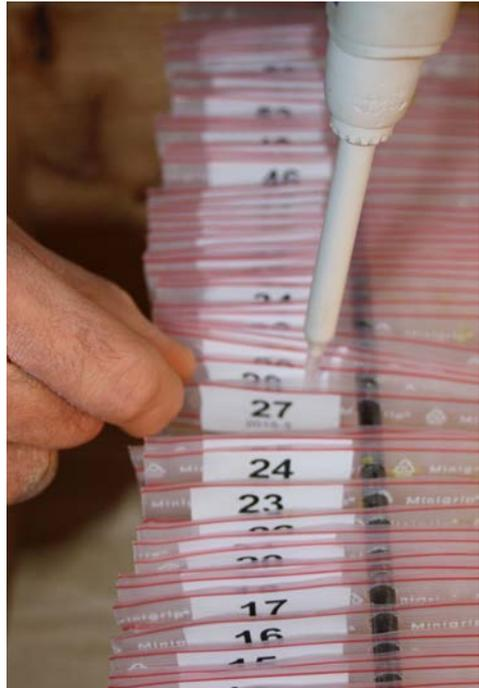
Abb 27: Kresstest - Dosierung des Hornmistpräparates mit der Mikropipette
