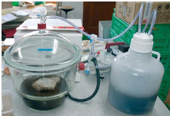
Abb. 15a: Einrichtung der Unterdruck-Inokulationsanlage. Dottenfelderhof 2009
