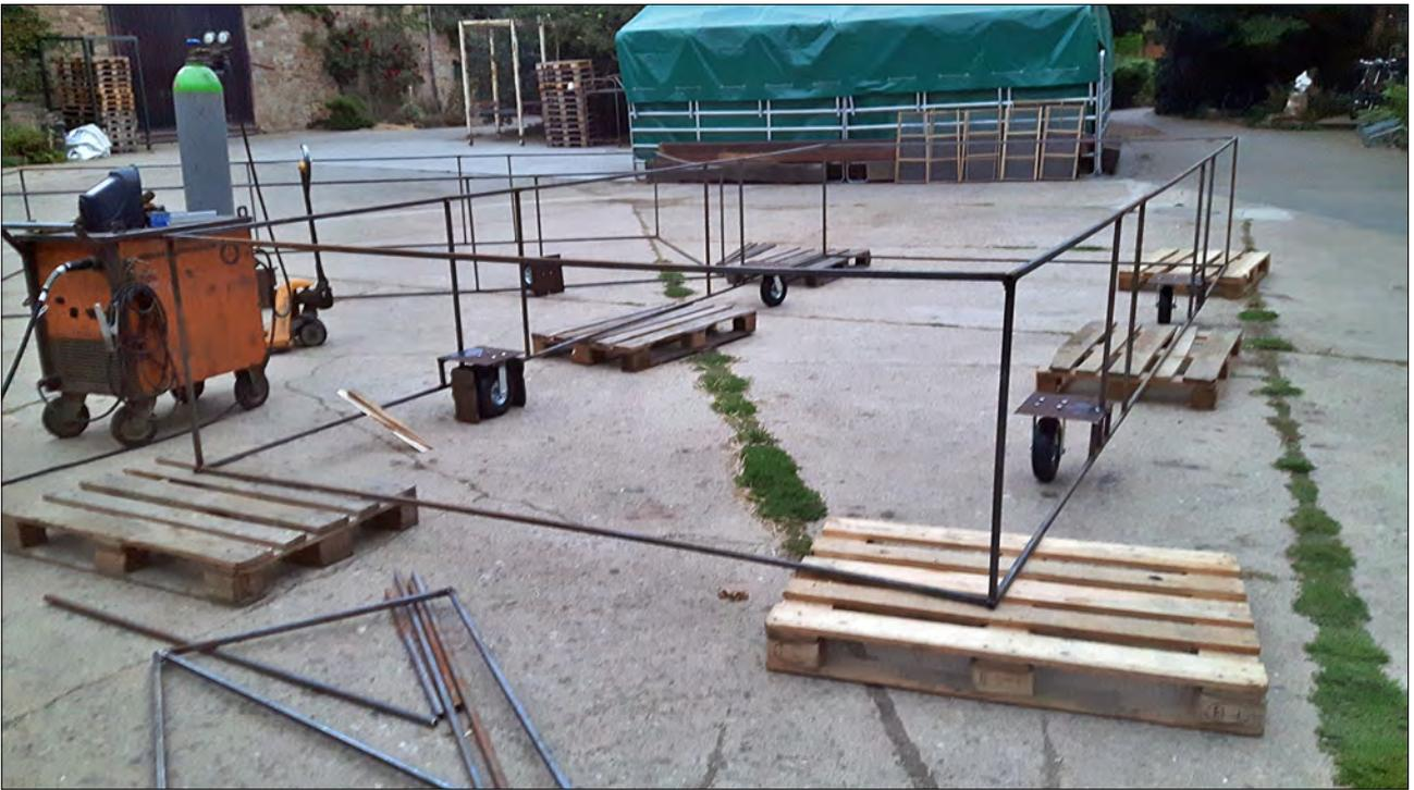
Zum Anbringen der Bockrollen ist eines der Mobile auf Paletten aufgebockt.
