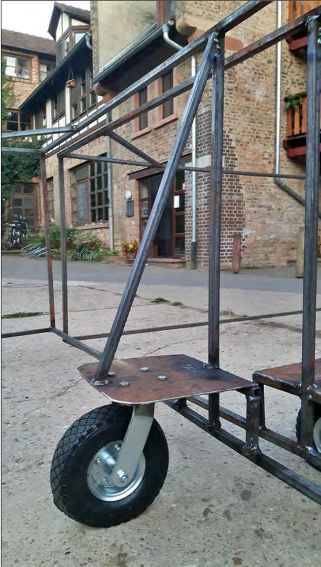
Links: Details einer „Radhaltekonstruktion“.
