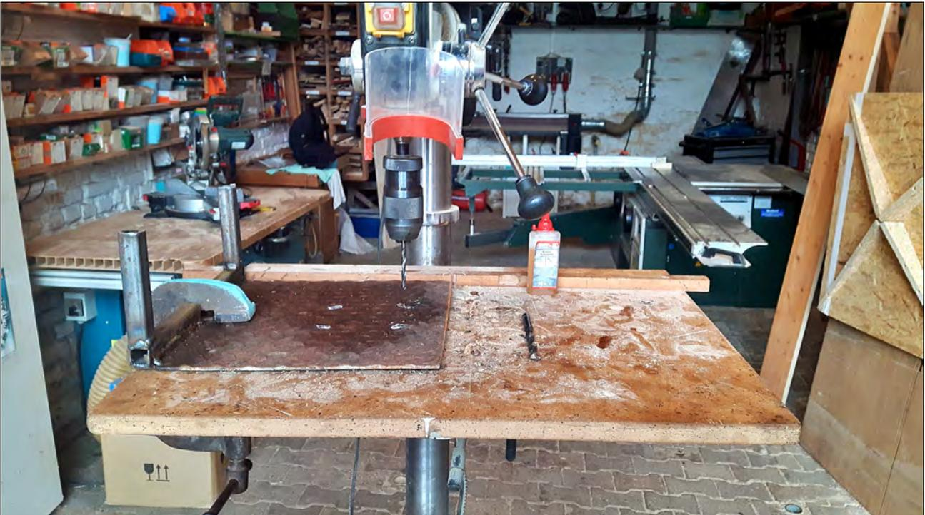
Bohrarbeit mit der Standbohrmaschine in der Hausmeisterwerkstatt. Durch die entstanden Löcher kommen nachher die Schrauben, mit denen die Bockrollen befestigt werden.
