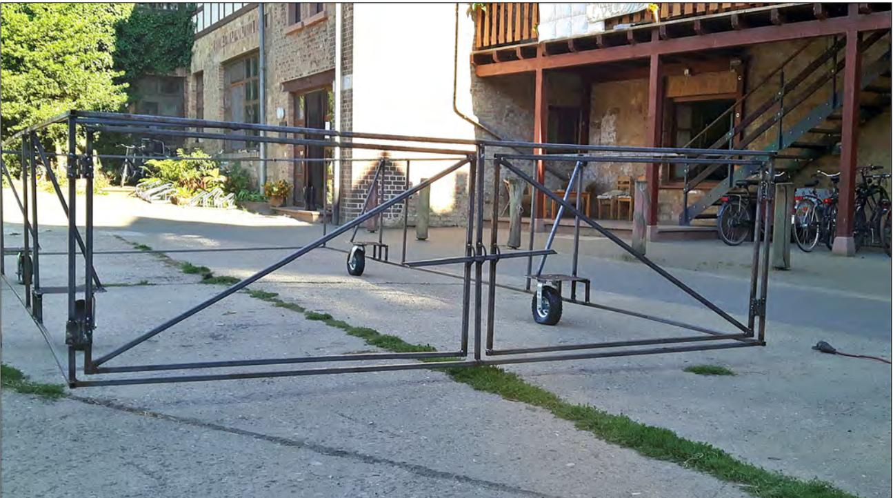
Und hier zwei fertig eingebaute Tore an einem der beiden Mobile. Die Scharniere wurden einfach an den Rahmen geschweißt. Die zu sehende Torverriegelung ist natürlich noch provisorisch!
