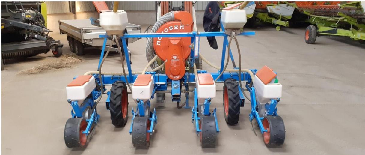
Präzise pneumatische Einzelkorn Sämaschine
