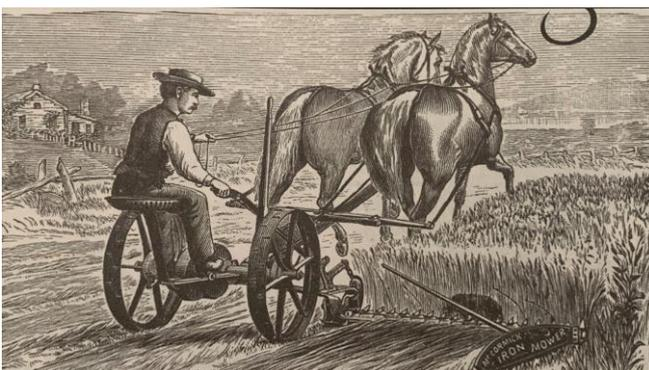
Sie werden entweder über den Boden angetrieben oder durch den direkten Zug der Pferde. Das erste Gerät, welches zum Einsatz kommt, ist das Mähwerk. Es hat auf der rechten Seite einen einfachen Fingerbalken, auf dem sich das Messer bewegt. Angetrieben wird es über das grosse Rad auf der linken Seite, das die Bewegung durch ein Getriebe auf den Antriebsbalken überträgt der das Messer
