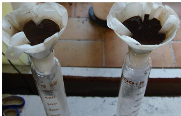
Abbildung 4: Messzylinder mit Trichter, Filter und je 100g Kultursubstrat (nach dreistündigem Wasserbad).
